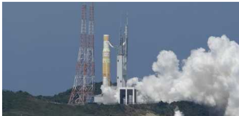
第1段実機型タンクステージ燃焼試験 (CFT)
