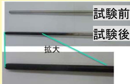
高温高压水(573K、15MPa)による腐食試験結果 一試料(純鉄)先端約10cmにマグネタイトが形成。
