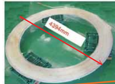
実機EFコイル ダブルパンケーキ巻線
