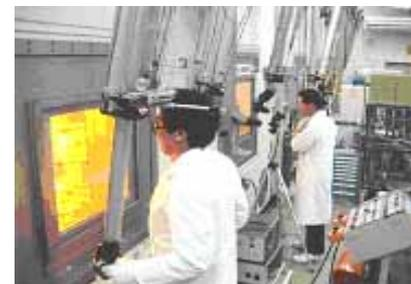
ホットセル遠隔操作試験状況
