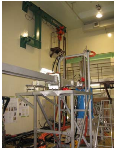
J-PARC用に新たに開発された大電力高周波源(クライストロン)
