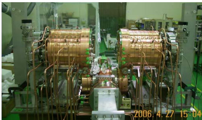
J-PARC用に新たに開発された軸対称な高周波加速空洞の原型機 (200-400MeV用)
