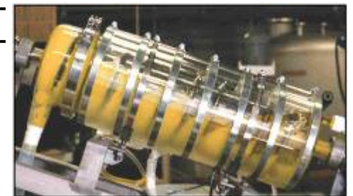
連続晶析装置概念(基礎試験装置)
