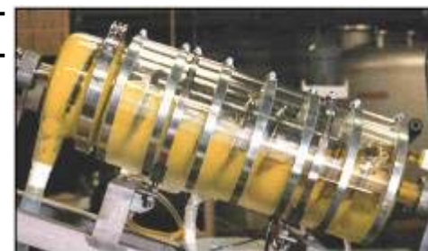
連続晶析装置概念(基礎試験装置)
