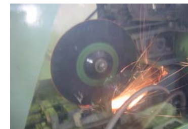
機械式切断治具による切断状況 (キュービトロン砥石)
