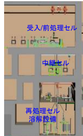
移行期プラントの前処理設備セル断面図
