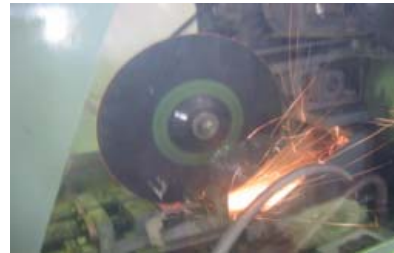
機械式切断治具による切断状況 (キュービトロン砥石)
