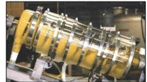
連続晶析装置概念 (基礎試験装置)
