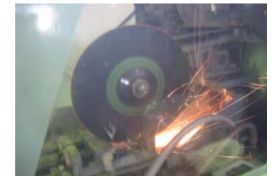
機械式切断治具による切断状況 (キュービットron砥石)
