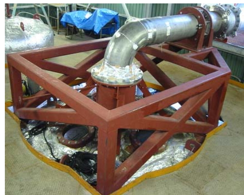
2)振動試験体(SUS管:内径41cm、板厚5mm)
