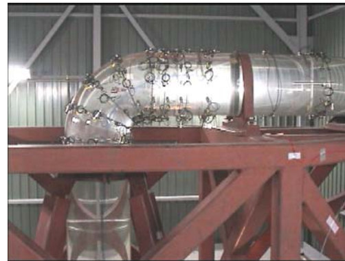
1)可視化試験体(アクリル管:内径41cm、板厚50mm)
