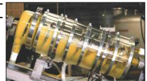
連続晶析装置概念(基礎試験装置)
