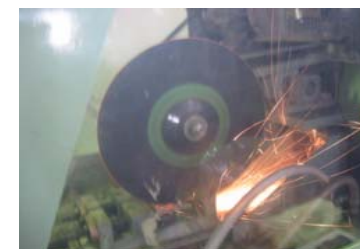
機械式切断治具による切断状況 (キュービトロン砥石)
