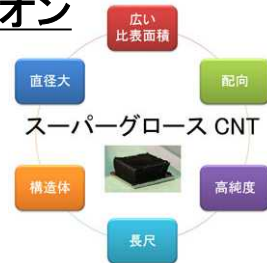
スーパーストラス法で合成されたCNTの特徴
