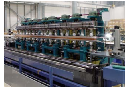
真空封止型アンジュレータ 短波長・高干渉性・高輝度な X線レーザーを発振
