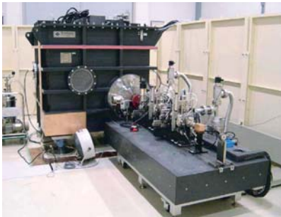
熱カソード型電子銃 より鋭い電子ビームを発生
