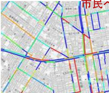
統合プローブカーデータの分析による局所的な速度低下区間の検出
