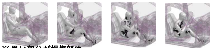
※黒い部分が損傷部位
