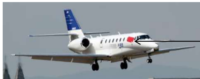
実験用航空機「飛翔」を用いたリブレット飛行実証試験
