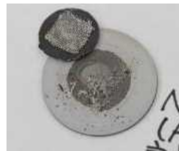
水素流量変動の影響で破損した固体酸化物形燃料電池
