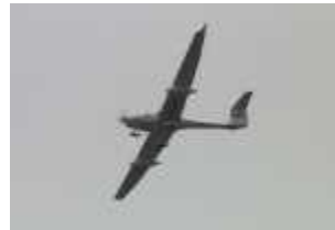
【上昇気流中で高度を維持しながらの電力回生(Regenerative Soaring)を行う飛行試験状況(⑦)】
