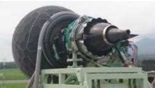
低騒音ノズル 屋外騒音計測試験
