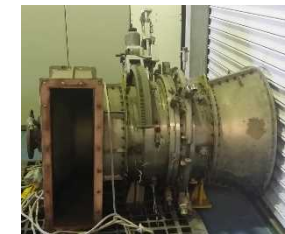
回転タービン試験設備(整備中)
