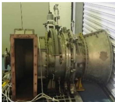
回転タービン試験設備 (整備中)
