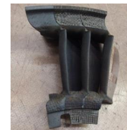
800Hrの試験後外観 (損傷なし)
