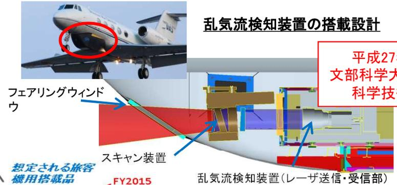
乱気流検知装置の搭載設計
