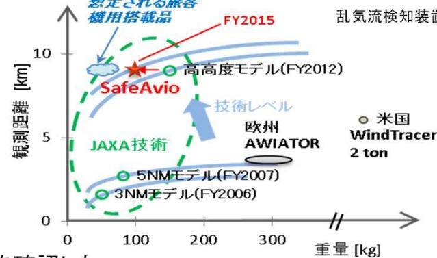
乱気流検知装置性能のベンチマーク
