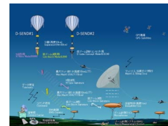
低ソニックブーム設計概念実証試験概要
