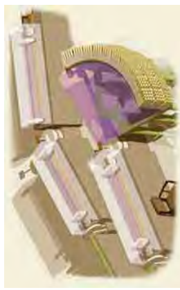
J-PARCに建設中の中性子スピンのエコー分光器群VIN-ROSE
