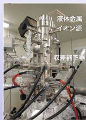
球面収差と色収差を補正する補正収差器を組み込んだ一次イオンコラム
