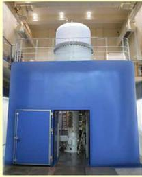
試料に透過させた電子波と、試料のないところを透過させた電子波を干渉させることにより生じたホログラムから、試料の電場が磁場、3次元像を解析することができる。
