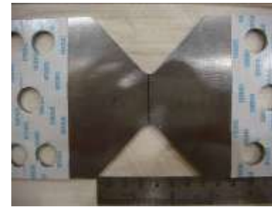
引っ張り試験に 用いた鉄資料
