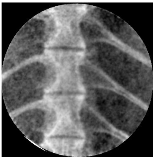
逆コンプトン反応で生成したX線による魚の骨の透過像
