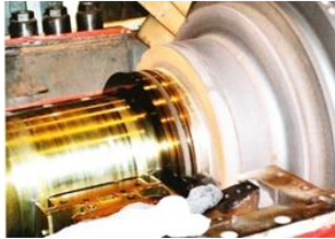
発電所のタービンの軸に付着したワニス
