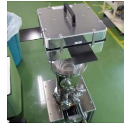
2軸疲労試験設備用極低温環境槽の整備
