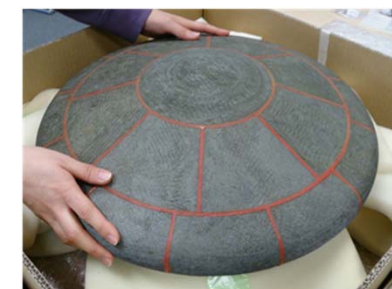
火星突入機TPS-φ500mm BBM
