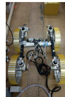
新規開発したサスペンション機構を有するローバ下部
