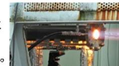
(C/C複合材燃焼器加熱試験)
