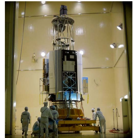
図 ASTRO-H 音響試験(5月)
