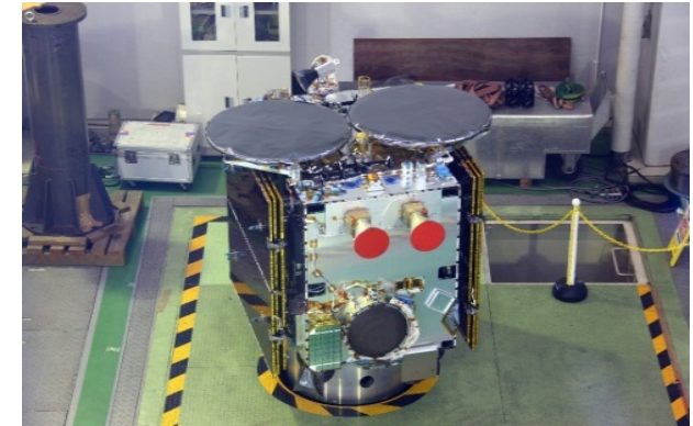
図:はやぶさ2「一次噛み合わせ試験」 質量特性試験
