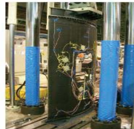
宇宙輸送本部・複合材ロケット構造強度試験 (圧縮試験。点検口周囲のひずみ分布を計測)
