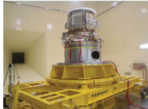
図3 第3段搭載機器音響試験
