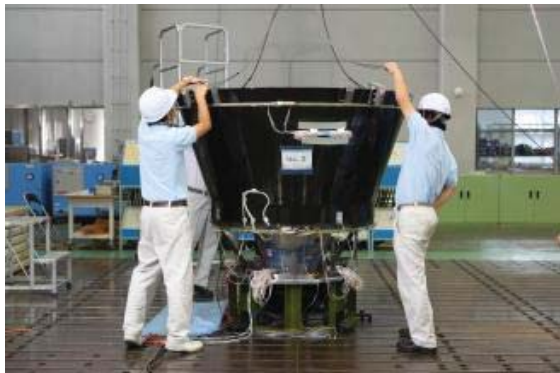
図1 2段ノズル伸展試験
