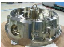
FY25 燃焼器単体試験に向け大型燃焼器を製造中
