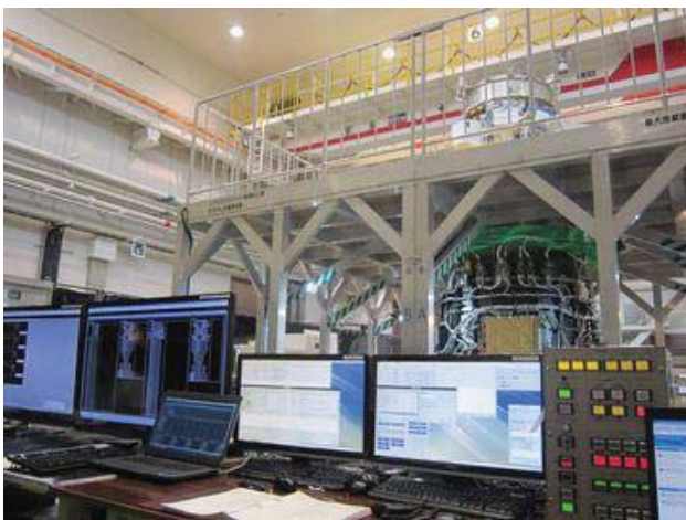
図1 2段ノズル伸展試験
