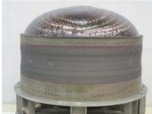
図2 3段モーターケースの試作
