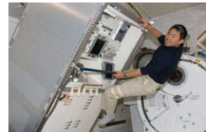
船内実験室内のラック移設作業
