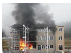
67 分後 出火室南側窓から火炎が噴出し、フラッシュオーバー
