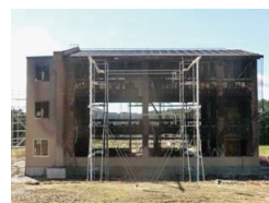
155 分後 消火開始 1680 分後（28 時間後） 実験終了後も倒壊なし
