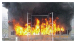
83 分後 1 階北側窓から火炎が噴出し、軒まで達する
