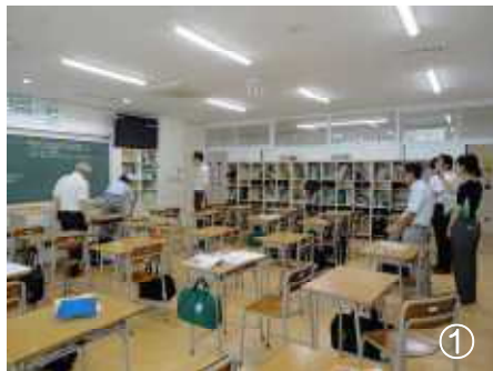
▲普通教室。改修により廊下側に1m拡幅し、生徒用ロッカーを常置できるようにした。
