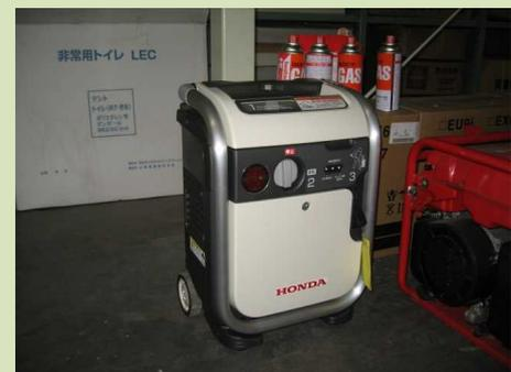
【カセットボンベ式ポータブル発電機】
