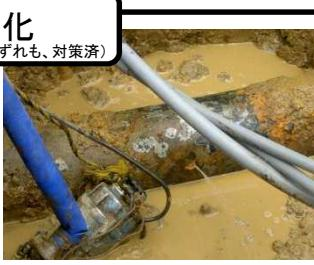
配管の腐食
