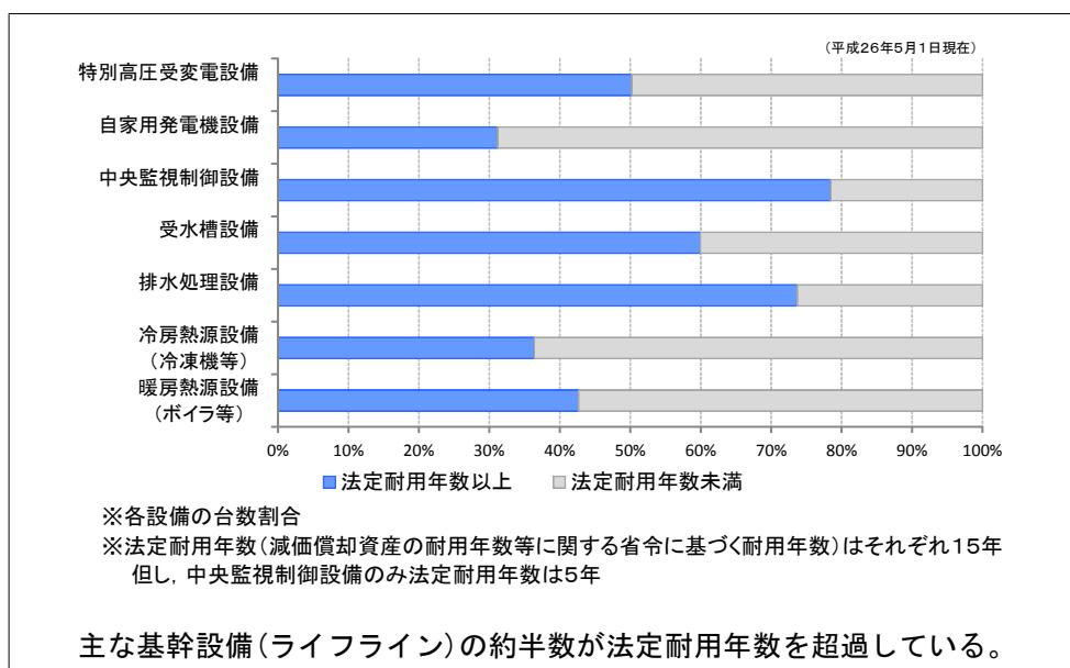
図5 主な基幹設備(ライフルライン)の老朽化状況
