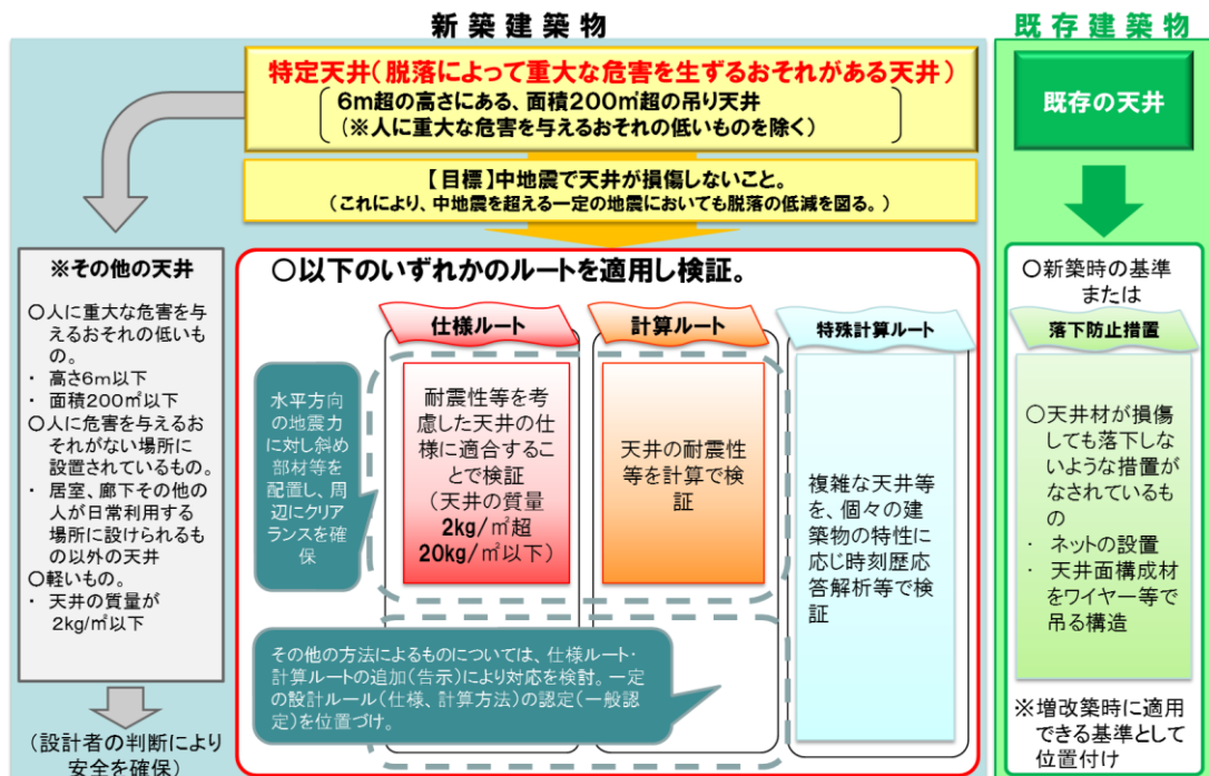
図〇 建築物における天井脱落対策に係る技術基準(概要)
