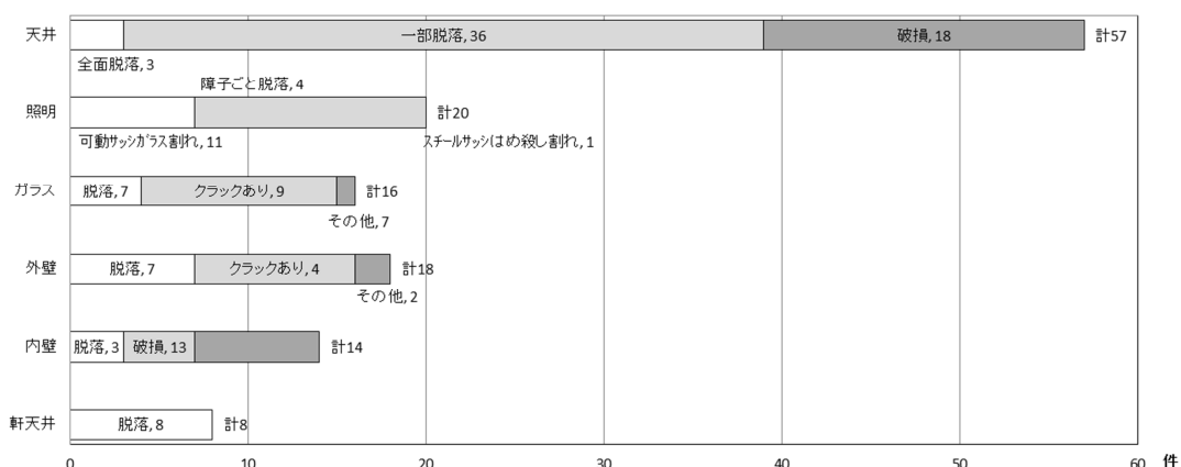
図3 武道場における非構造部材の被害
