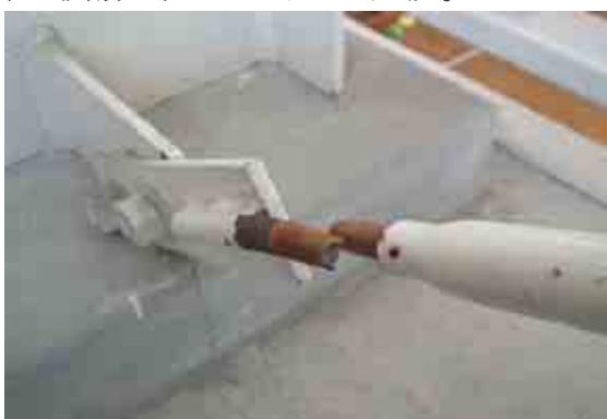
ターンバックルプレースねじ部での早期破断
