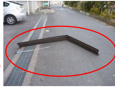
屋根材の一部が強風により剥離 (築26年)
