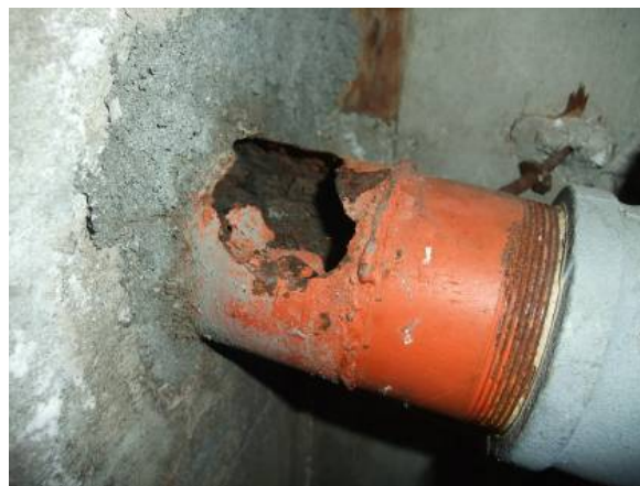
屋外の消火管の破裂。消火栓が使用できなくなり、一時的に消火器で対応
