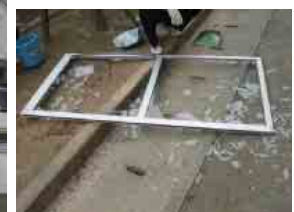
落下して破損した障子
