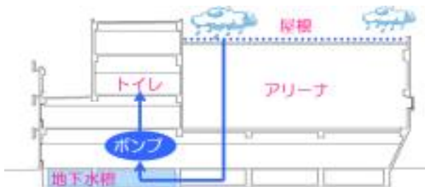
アリーナの屋根に降った雨をポンプでくみ上げ、 トイレの洗浄に利用（東京都江戸川区立松江小学校） （浅川委員提供）
