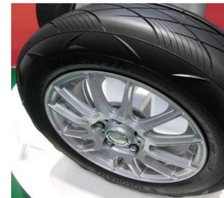
自動車用タイヤ空力形状設計:空気抵抗と揚力を同時に低減できる画期的な形状を発見。右図は東京モーターショー2015で展示された試作品
