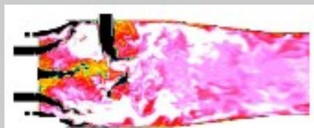
**タービンの実利用環境**（3.0MPa程度までの亜臨界状態）**における**実機燃焼器内のガス、噴霧、微粉炭燃焼のLES**解析が可能**となった。
