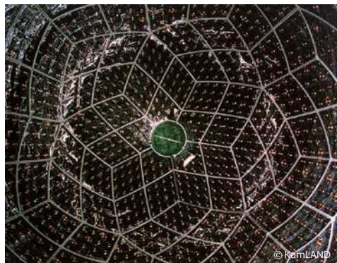
ステンレス球の内面に設置された光電子増倍管。
