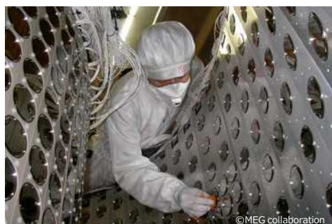
液体キセノンガンマ線検出器。側面の円盤がガンマ線が入ったときに生じる光を検出する装置になっている。
