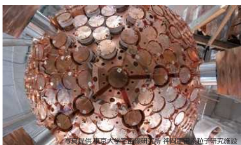
写真提供 東京大学宇宙線研究所 神岡宇宙線粒子研究施設 液体キセノンが入っている検出器の中心部分。円盤一つ一つが光電子増倍管とつながっている。
