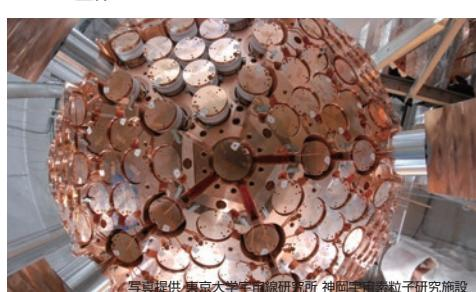
液体キセノンが入っている検出器の中心部分。円盤一つが光電子増倍管とつながっている。
