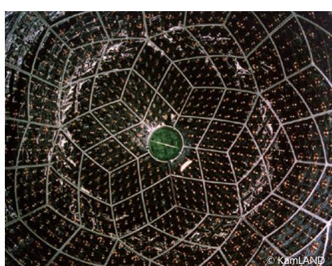
スレンレス球の内面に設置された光電子増倍管。
