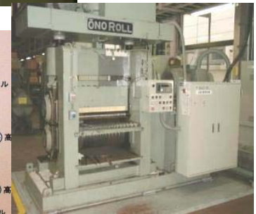
NIMSの材料創製装置インフラ群 (津崎グループ) (20kg高周波真空溶解, 300トン鍛造機, 超清浄浮揚溶解炉, 150トン溝ロール圧延機)
